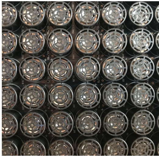
Mini Ultrasound Speaker Array
