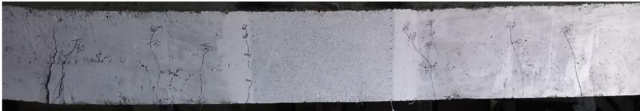
(d) GFRP Reinforced Beam with 0.70% PO Fiber
